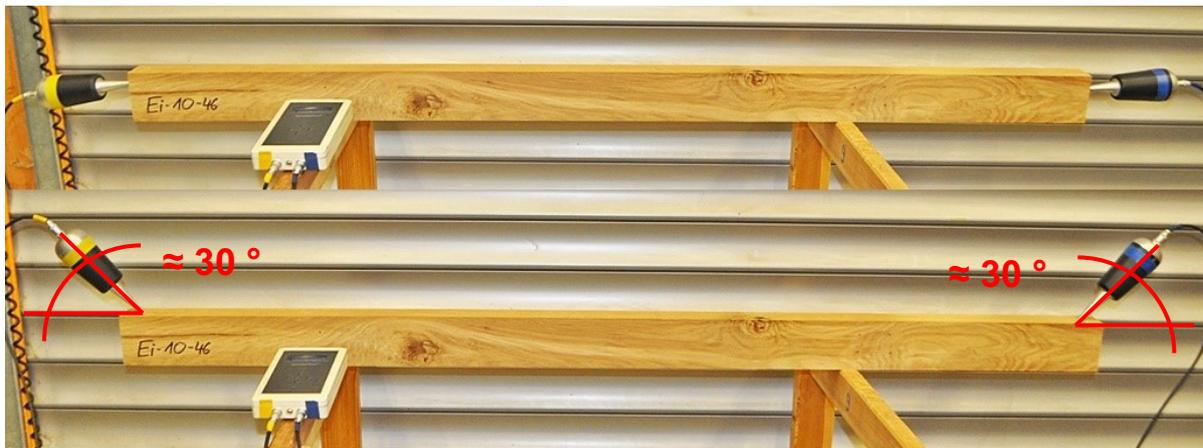
**Abbildung 45: Durchführung der Ultraschall-Impulslaufzeitmessungen – oben: direkte Längsdurchschallung; unten: indirekte Längsdurchschallung (Bildquelle: Linke, 2019)**
