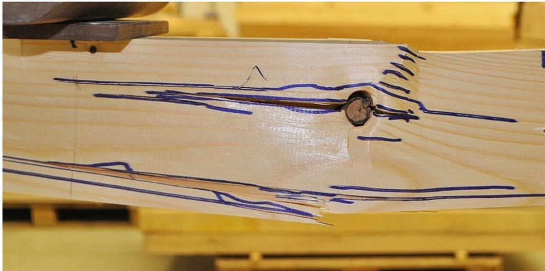
**Abbildung 64: Bruchverhalten – Prüfreihe „Fichte“ – Versagen durch Zug- & Druckbruch**
