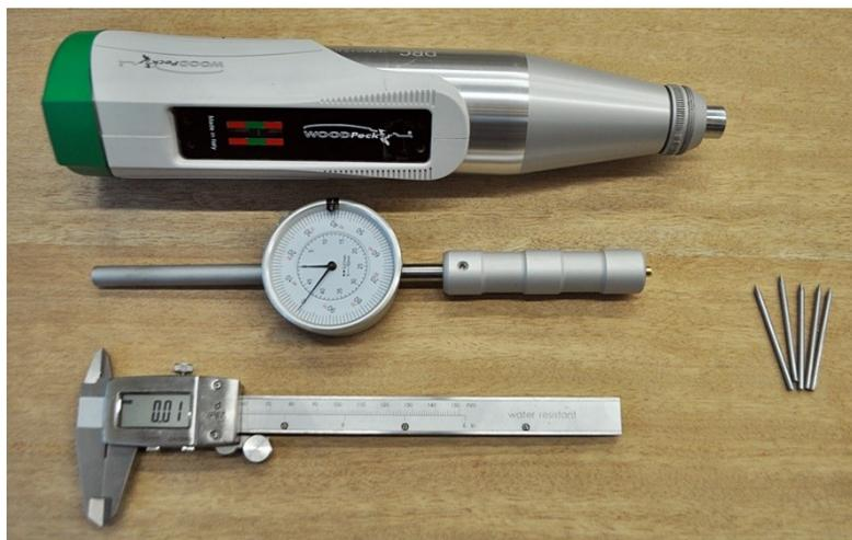
Abbildung 103: Prüfgerät „WoodPecker Wood Test Hammer“ der Fa. DRC Italia – oben: Impulshammer; Mitte: analoge Messuhr; unten: digitaler Messschieber; rechts: Schlagstifte (Bildquelle: [Rug/Linke, 2017])
