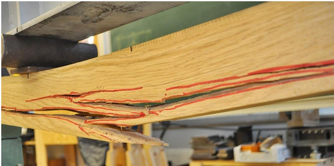
**Abbildung 70: Bruchverhalten – Prüfreihe „Eiche“ – Zugbruch mit Rissfortsetzung**
