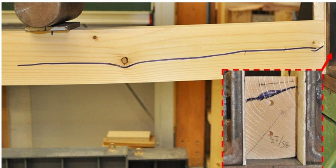
**Abbildung 65: Bruchverhalten – Prüfreihe „Fichte“ – Schubversagen**
