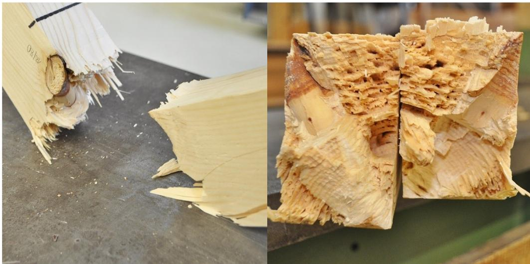
Abbildung 62: Bruchverhalten – Prüfreihe „Fichte“ – Zugbruch über gesamte Querschnittshöhe
