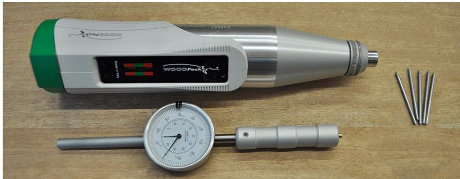
**Abbildung 41: Prüfgerät zur Eindringtiefmessung – Woodpecker Wood Test Hammer (Fa. DRC Italia, Ancona/Italien, Bildquelle: [Rug/Linke, 2017])**
