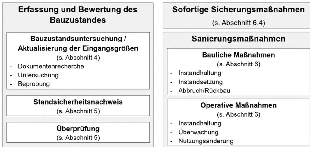
**Abbildung 16: Ablauf der Bauzustandsbewertung und Instandsetzung bestehender Konstruktionen nach [JRC, 2015] (die enthaltenen Verweise beziehen sich auf die Abschnitte in [JRC, 2015])**
