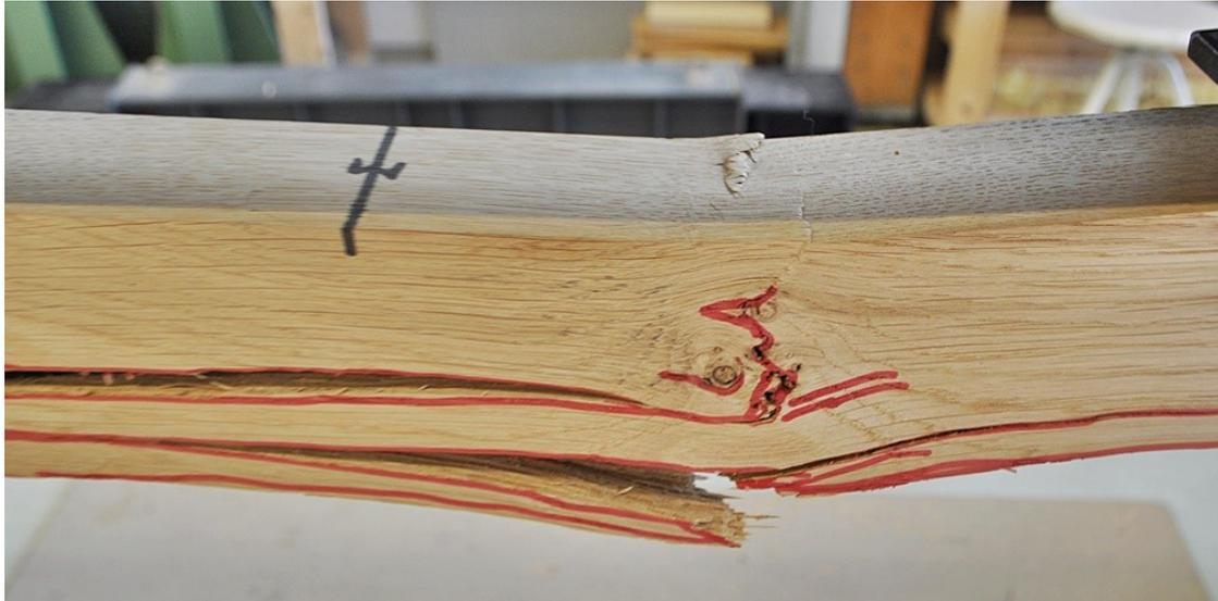
**Abbildung 71: Bruchverhalten – Prüfreihe „Eiche“ – Versagen durch Zug- & Druckbruch**
