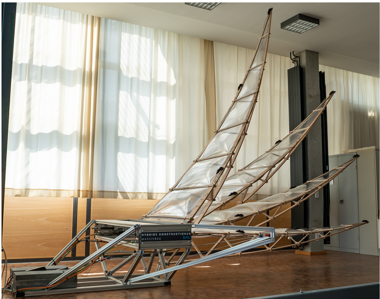
Abb. 13: Demonstrator in mehreren Transformationszuständen von geschlossen bis vollständig geöffnet
