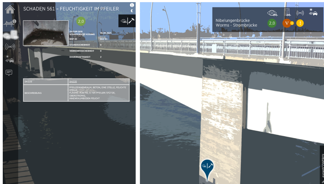
Abb. 12: Konzeptionelle Visualisierung des Anwendungsfalls Dokumentation der regelmäßigen Bauwerksprüfung anhand eines Beispielschadens im Condition Control. Quelle: MKP GmbH
