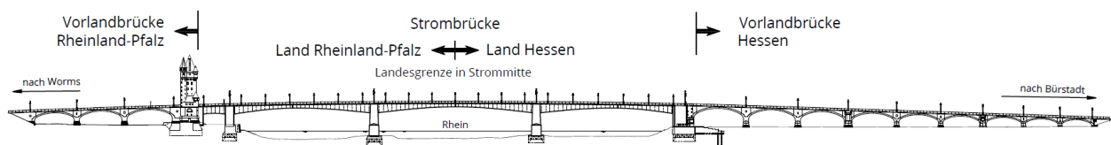
Abb. 2: Ansicht der Nibelungenbrücke (in Richtung Unterstrom)
