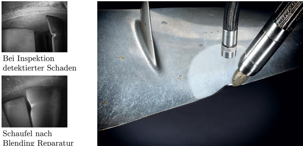
Abbildung 1.1: Beispielhafte Blending Reparaturen [1, 130]
