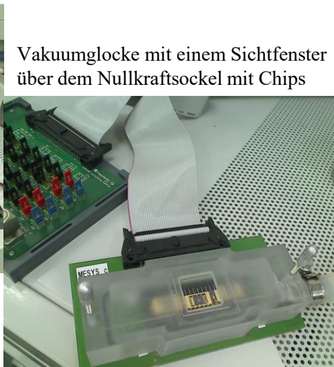
Abbildung A. 1: Messaufbau für die Messungen der NED-Aktoren im Unterdruck.
