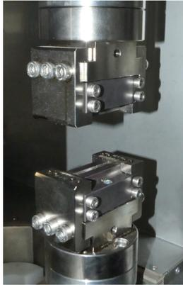
Abb. 5.2: Flache Spannbacken der Prüfmaschine von ZWICK&ROELL (T-Probenhalter)
