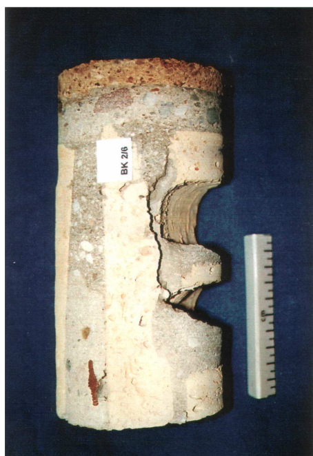
Abb. 10-9: Arbeitsfuge zwischen unterem und oberem Fugenteil
