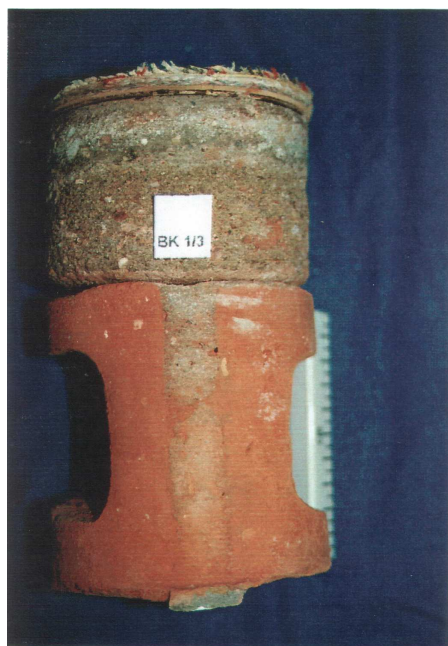
Abb. 10-5: Druckschicht durch Arbeitsfuge unwirksam
