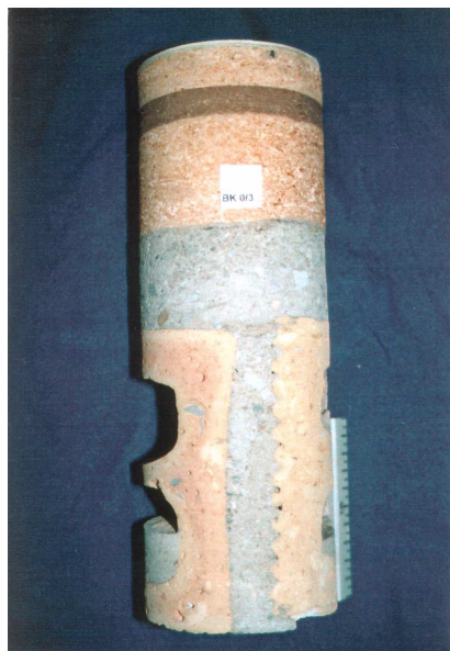
Abb. 5-4: Bohrkern eines Hohlziegels mit starken Rillen in einer Wandung
