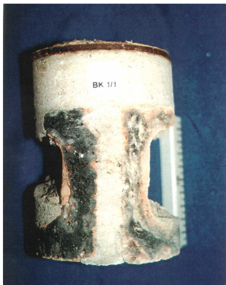
Abb. 10-8: im Druckbereich verstärkter Hohlziegel, verdreht eingebaut
