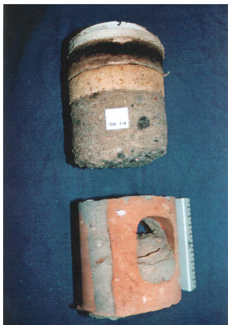
Abb. 10-12: Kleinesche Decke mit Mischgut im Hohlraum
