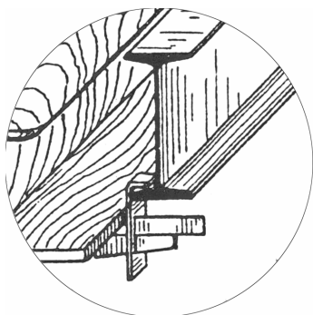
Abb. 5-15: Flacheisen als Schalungsträger
