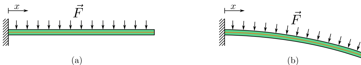
Abb. 4.13: Darstellung der Kräfteeinwirkung \vec{F} auf den NED zu Beginn (a) und während der Aktuierung (b). Der NED (grün) ist hierbei als einseitig eingespannter Balken modelliert. Dessen neutrale Faser ist orange eingezeichnet.
