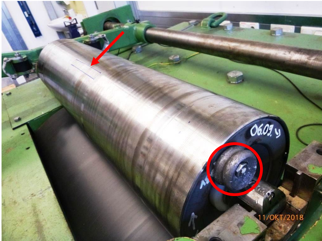
Abbildung 37: Prüftragrahne #0609 mit Klebestreifen (Pfeil) und Massestücken (Kreis) im Tragrollenprüfstand [27]
