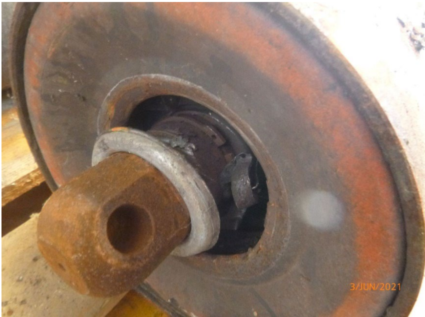
Abbildung 68: Mitteltragrolle #1964 (beidseitiger Lagerschaden vorliegend)
