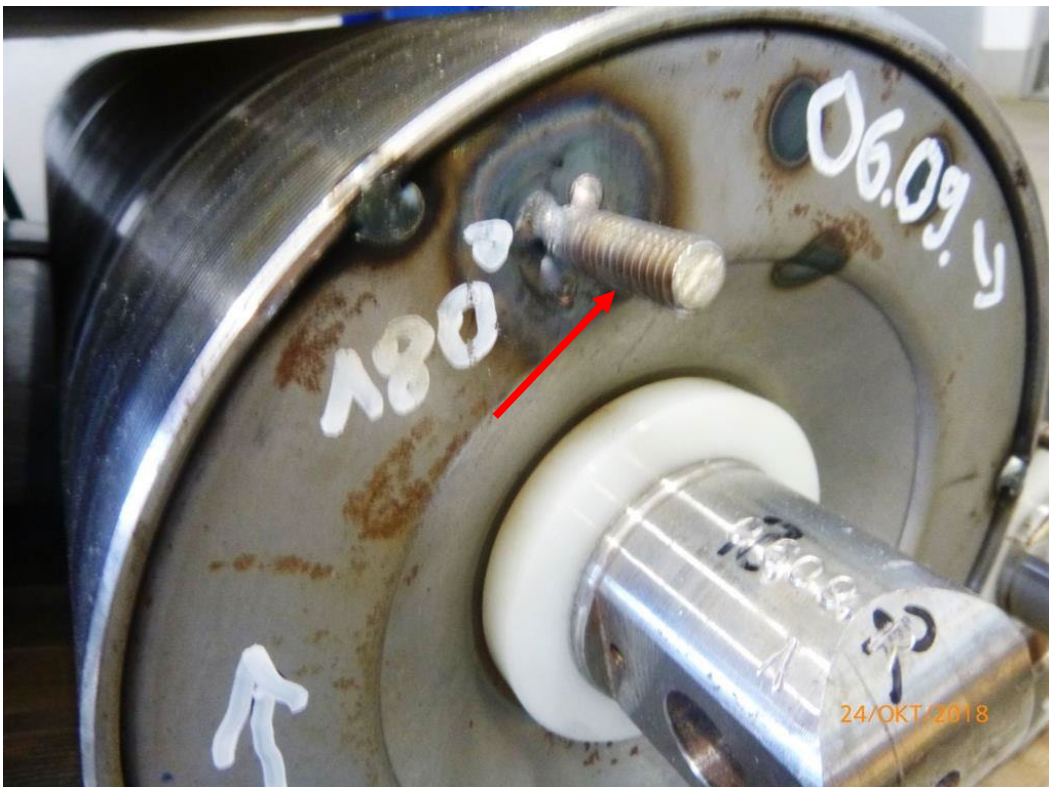
Abbildung 32: modifizierte Prüftragrolle #0611 mit den seitlich angebrachten Gewindestangen für die zusätzlichen Massestücke (roter Pfeil) [27]
