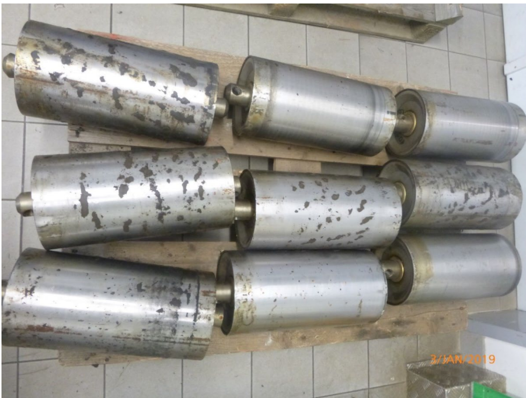
Abbildung 31: Anfangszustand der Tragrollen Typ A194x380-6310-G1-21-L [27]
