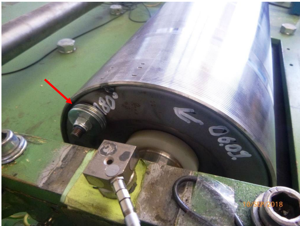
Abbildung 35: Prüftraggrolle #0609 mit Massestücken (roter Pfeil) im Tragrollenprüfstand [27]
