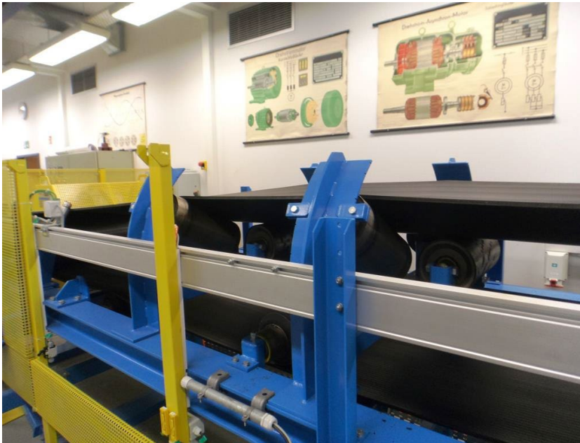
Abbildung 59: Versuchsförderer der BTU Cottbus-Senftenberg [26]
