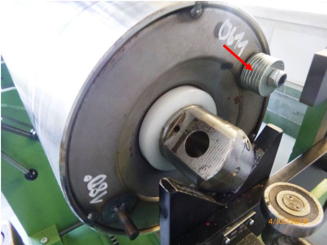
Abbildung 27: Prüftragrolle #0611 mit Massestücken (roter Pfeil) im Unwuchtprüfstand [14]
