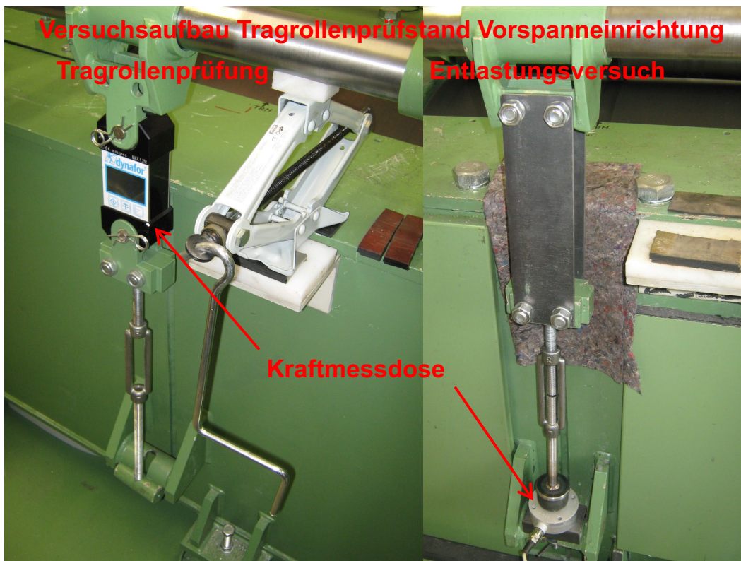
Abbildung 42: Umbau Vorspanneinrichtung Entlastungsversuch
