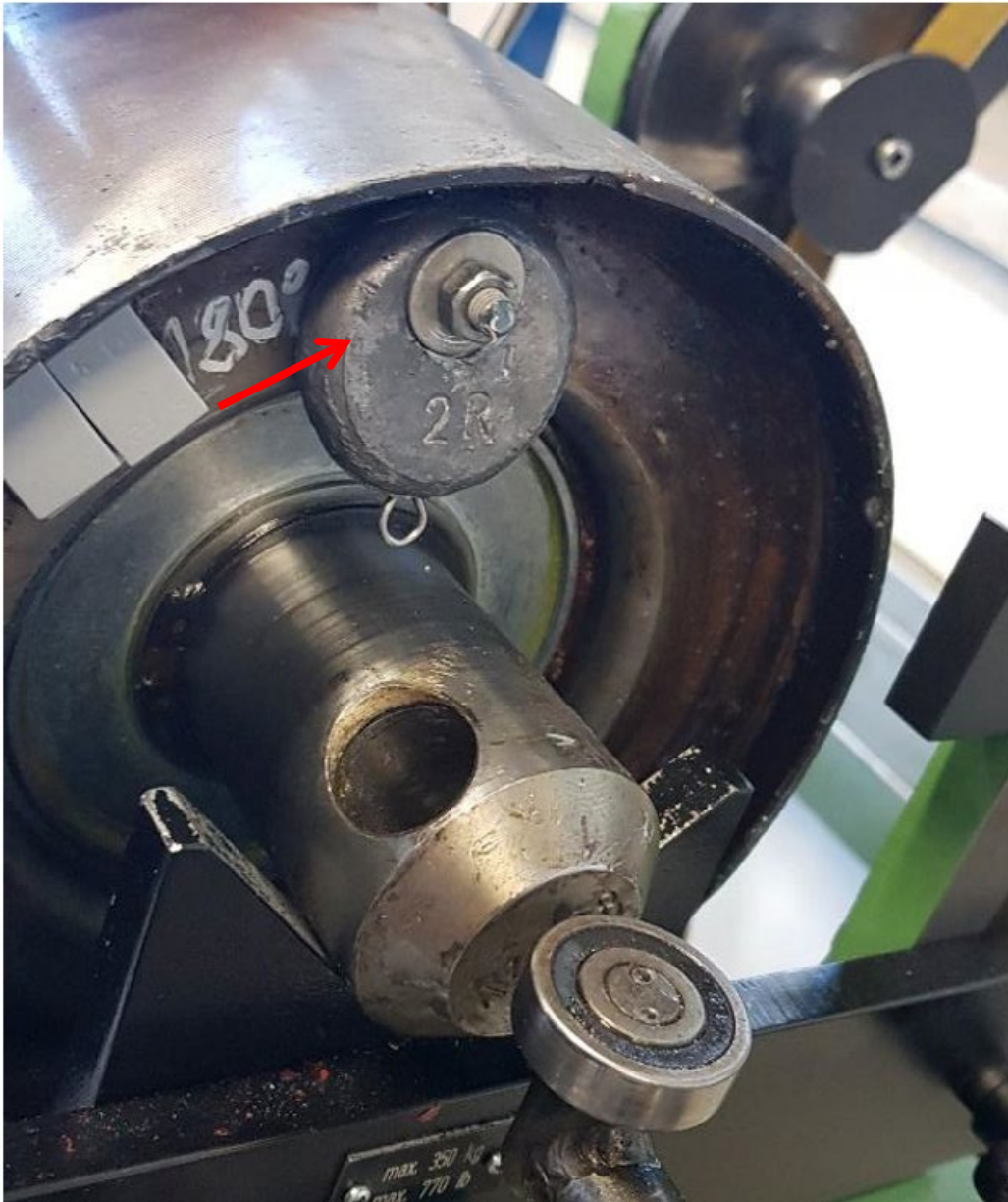
Abbildung 61: rechte Tragrollenseite mit 150g Massestück bei 180° [26]
