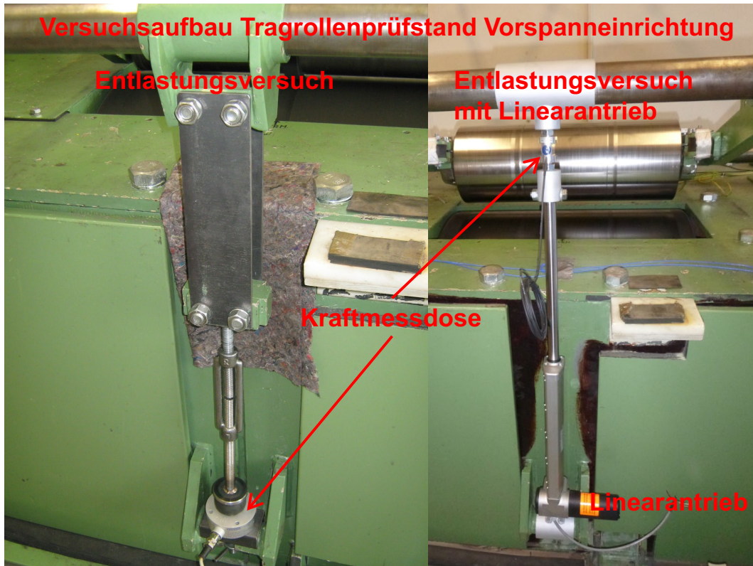
Abbildung 50: Umbau Vorspanneinrichtung Entlastungsversuch Linearantrieb
