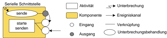
Abbildung 3.21: Konzeptionelle Lösung für das State-Constraint-Problem
