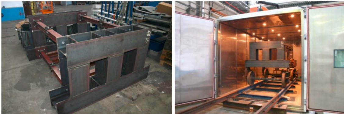
Abb. 2-8: Versuchsrahmen, Schienenfahrzeug für Verschub und Einbausituation im Großklimaraum
