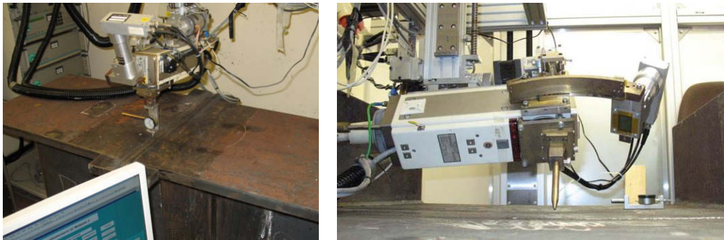
Abb. 2-12: Eigenspannungsmessung durch Röntgendiffraktometrie, ifs [P858-14]
