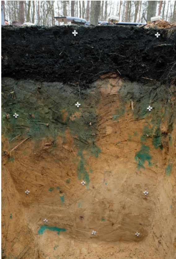
Abbildung 37: Farbtracer-Infiltrationsexperiment zur Veranschaulichung der Fließwege des Wassers in tiefere Bodenschichten (Foto: © BTU, A. Schneider).
