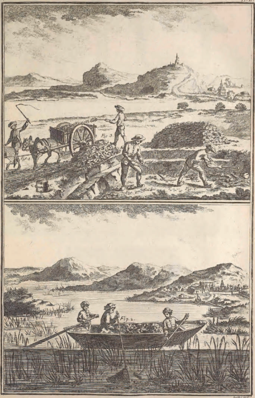
Forges, 1 re Section, Tirage et transport de la Mine en Gréus et de la Mine Phénixille.
