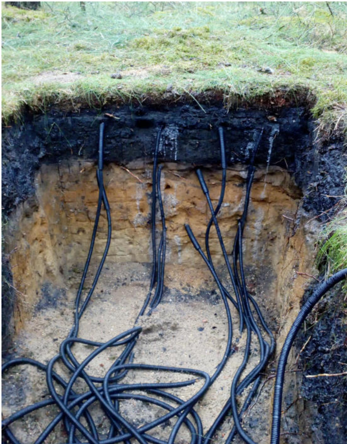
Abbildung 36: Einbau der Sensoren in den Profilschnitt durch den Holzkohlemeiler (Foto: © BTU, A. Schneider).
