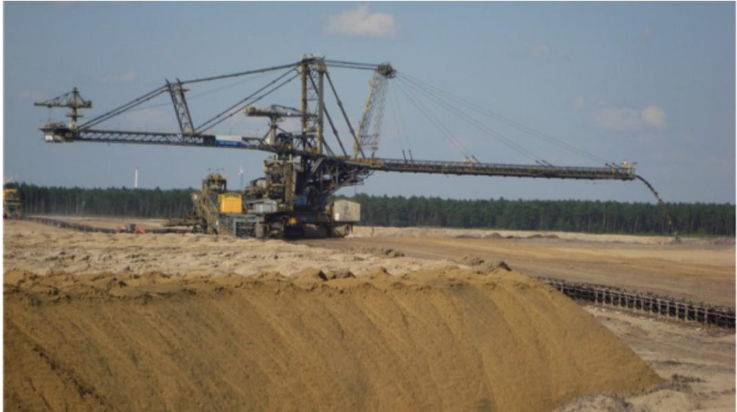
**Fig. 2:** In der Lausitz werden eiszeitlich abgelagerte Sande mit Hilfe von Förderbändern zu einem Bandabsetzern im rückwärtigen Raum des Tagebaus transportiert
