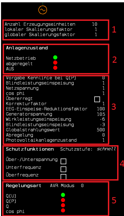
Abbildung 27: Leittechnikbild Photovoltaik Anlage
