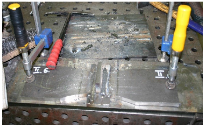
Abb. 21: Einspannung der Probe während des Reparaturschweißens
