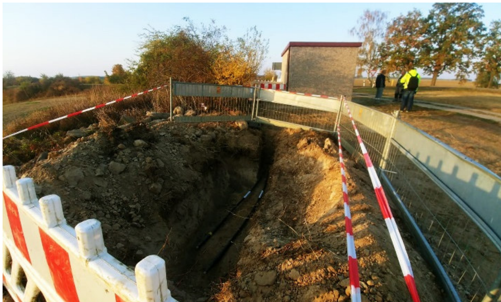
Abb. 1 Versuchsstation mit präpariertem Kabel
