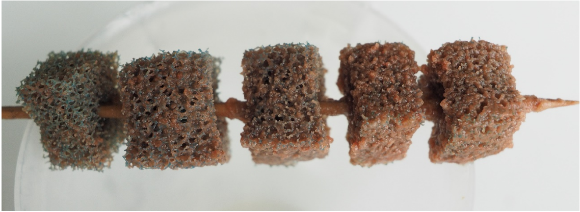
Abbildung 58 bewachsene Träger des membranbelüfteten Niedrigtemperatur-Festbettreaktors am Ende der Phase M24.
