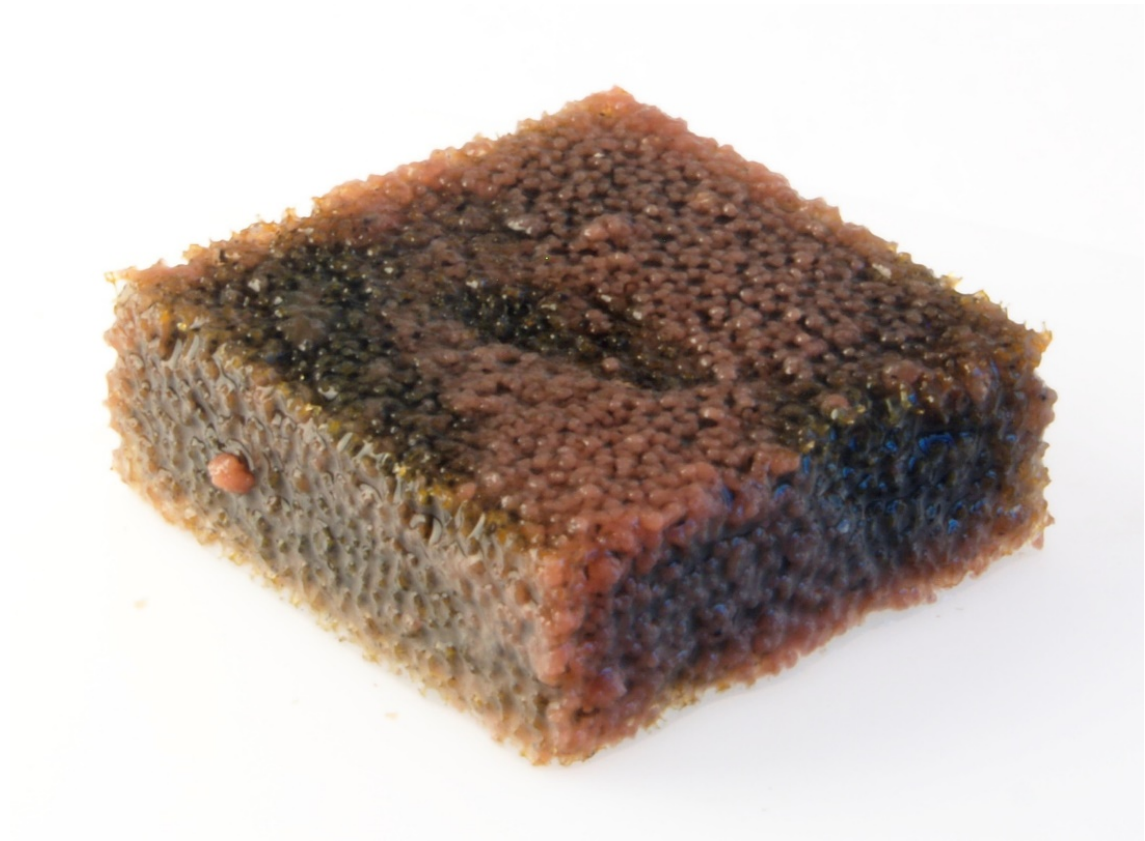
Abbildung 56 bewachsener Levapor-Träger aus einem der Anammox-Reaktoren, betrieben mit synthetischem Nährmedium.
