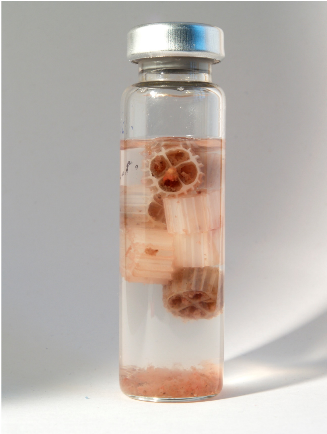
Abbildung 62 Ein Vial der Lagerungstests der, mit Anammox-Biomasse bewachsenen, Kaldnes K1-Träger.
