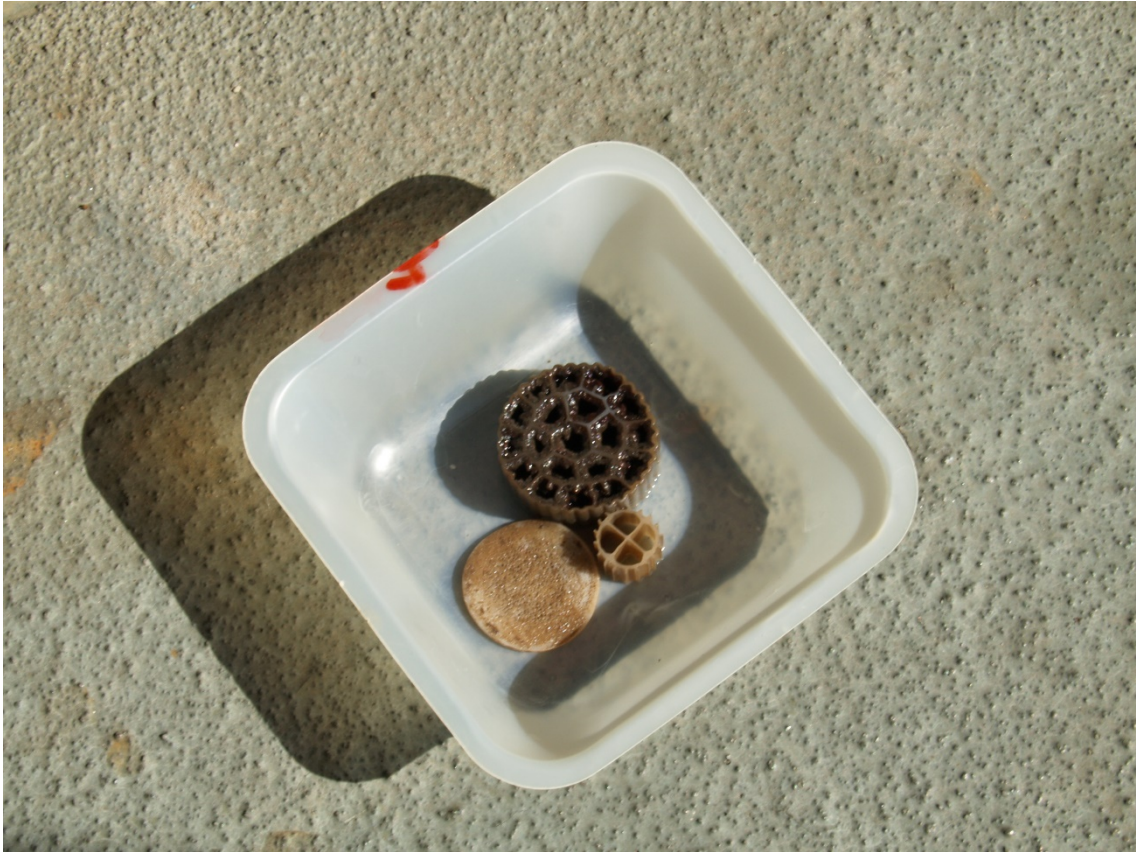
Abbildung 61 mit Anammox-Bakterien bewachsene Kaldnes K3-Träger (oben) Kaldnes K1 Träger(Mitte) aus einem, mit synthetischem Nährmedium betriebenen, Anammox-Reaktoren. Mit diesen wurden die Lagerungsversuche durchgeführt. Die Biochip-Träger (Multi Umwelttechnologie AG, Aue, Deutschland) (unten) wurden nur in geringen Stückzahlen probeweise in den Reaktor gegeben.
