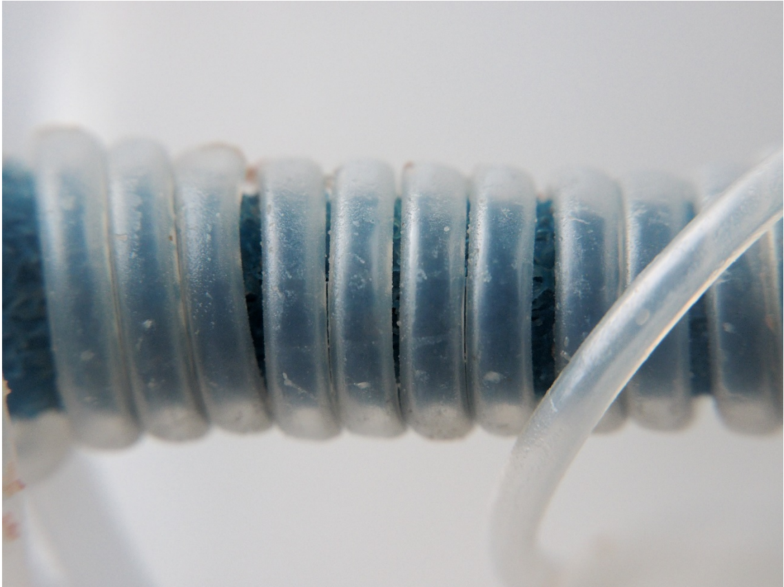
Abbildung 60 Biofilm auf der Membran des membranbelüfteten Niedrigtemperatur-Festbettreaktors am Ende der Phase M24.
