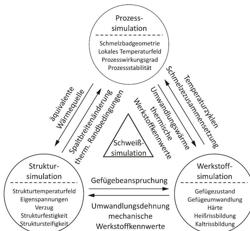
Abbildung 17: Teilbereiche der numerischen Schweißsimulation [47]
