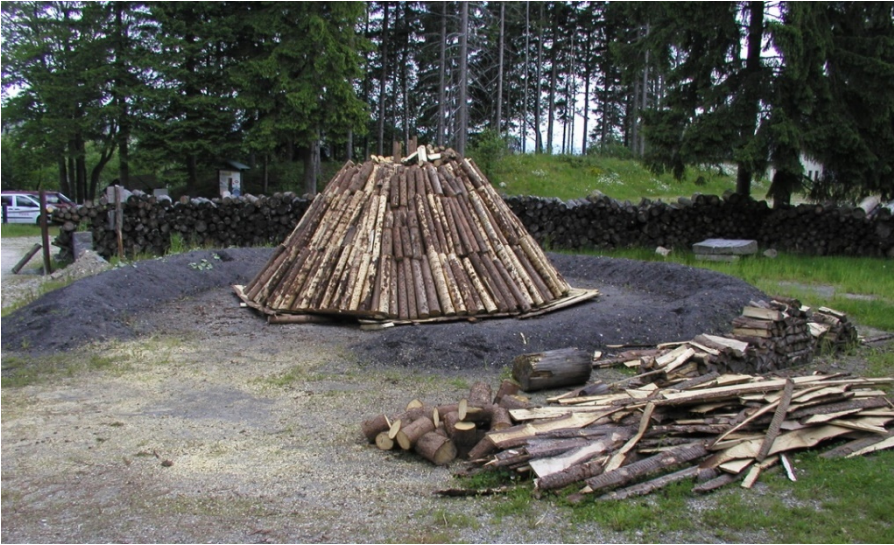
Abbildung 3: Rekonstruktion eines historischen Meilers im Fichtelgebirge (Aufnahme T. Raab, 2005).
