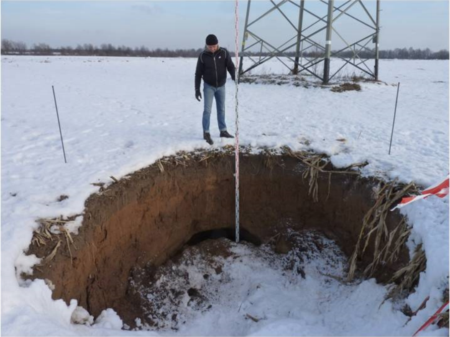
Abbildung 13: Eingebrochener Mergelschacht bei Pulheim-Geyen, Januar 2010. Hinter dem Zollstock ist der Gewölbeansatz der noch teilweise intakten Kammer zu erkennen. (Foto: Horst Engel, Pulheimer Bachverband).
