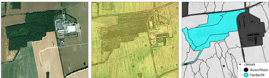
Abbildung 13: DOP (li.), DGM (mi.) und Klassifikation „Ausschluss“ und „Verdacht“ nach optimalster Anpassung in eCognition (re.) (Noack 2019, Geodaten: Esri et al. 2018; LGB 2018).
