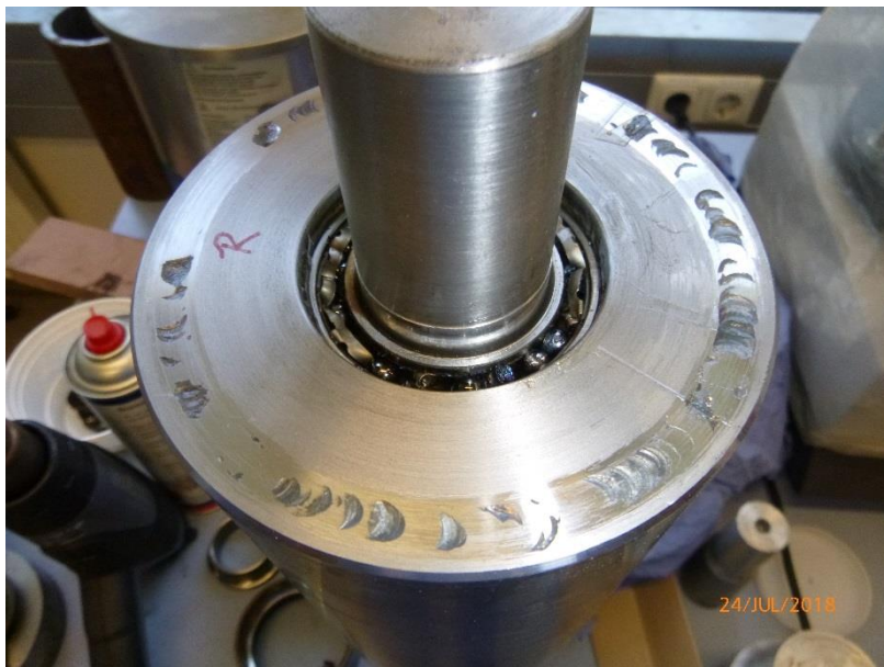
Abbildung 1: Zerstörtes Wälzlager in einer Prüfrolle
