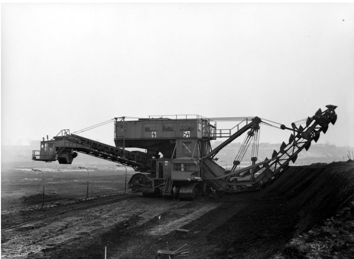
Abbildung 1: Schaufelradbagger aus der Grube Waidmannsheil, 1930 [4]
