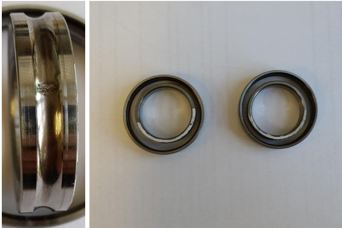
Abbildung 7: Testlauf 18002 rechter Innenring mit Schaden, demontierte Lagerringe
