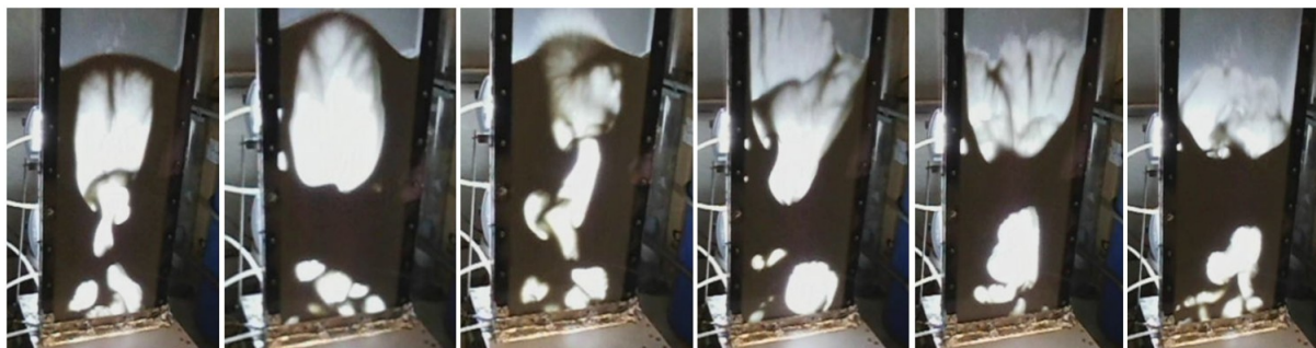
Abbildung 114: Veranschaulichung der intensiven Feststoffdurchmischung in einer blasenbildenden Wirbelschicht
