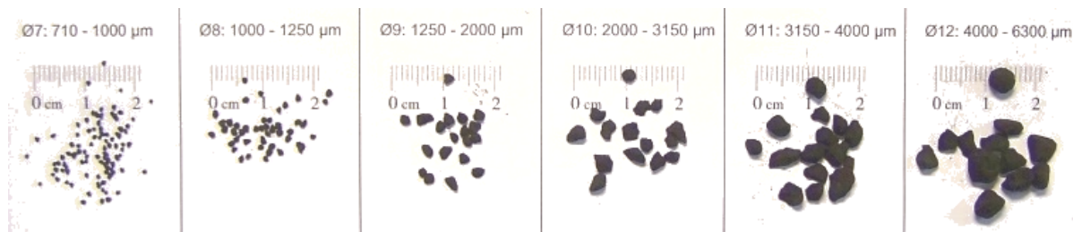
Abbildung 113: Veranschaulichung der Korngrößenklassen D7 bis D12 der insgesamt 13 Korngrößenklassen
