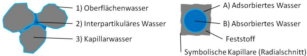
Abbildung 41: Wasserarten am Partikelagglomerat und in der Kapillare des einzelnen Kohlepartikels
