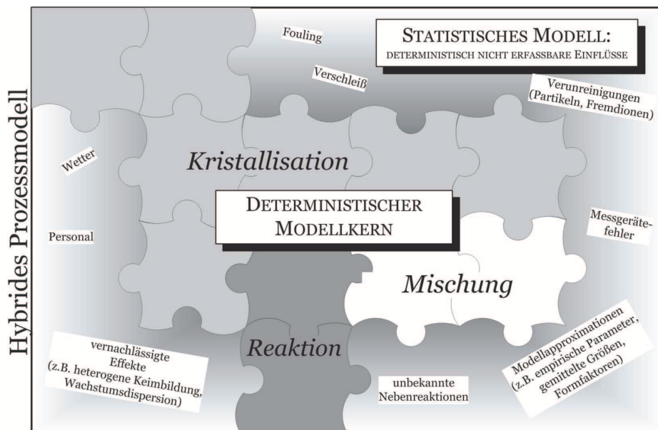
Fig. 0.3: Konzept eines hybriden Prozessmodells. Beispielhaft für industrielle Prozesse mit deterministisch beschreibbarer Reaktion, Kristallisation und Mischung.
