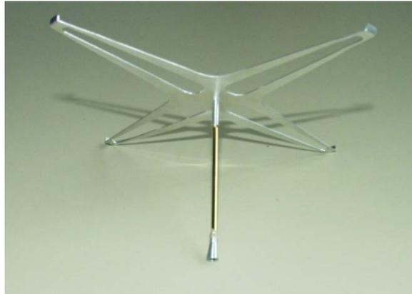
Abbildung 3.13: Waagschale mit vergoldetem Glasrohr als thermischen Isolator
