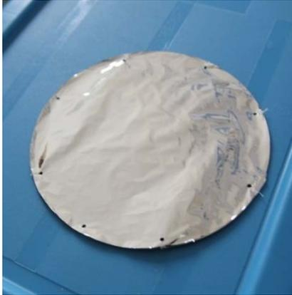
Abbildung 3.2: Segelfolienprobe
