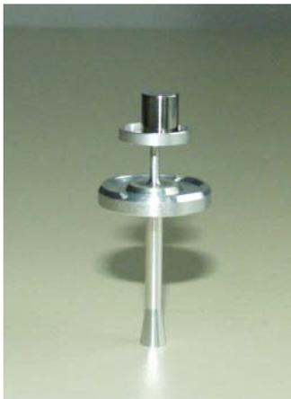
**Abbildung 13:** Kalibrierwaagschalen mit 2g-Kalibriergewicht
