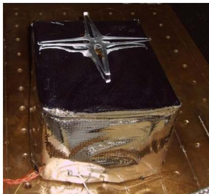
Abbildung 3.12: Waage mit MLI-Haube auf einer Temperierplatte
