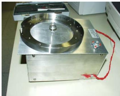
Abbildung 3: Wägezelle der Präzisionswaage
