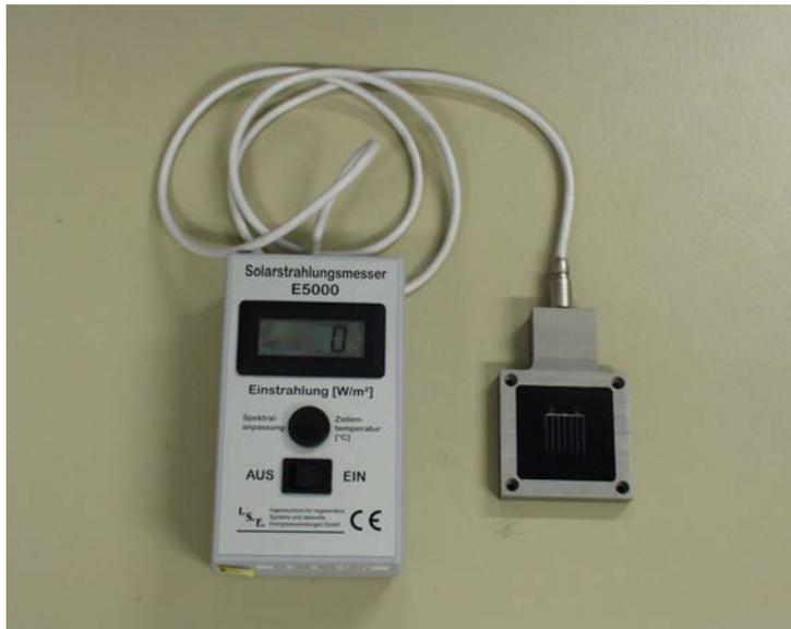
**Abbildung 7:** Solarstrahlungsmesser E 5000
