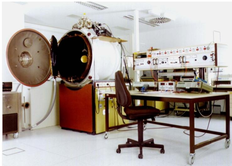
Abbildung 3.8: Sonnensimulationsanlage (SSA)
