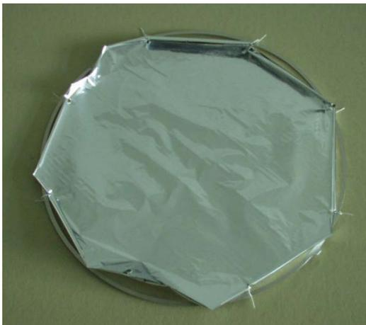
Abbildung 3.4: Mylarprobe nach Bestrahlung
