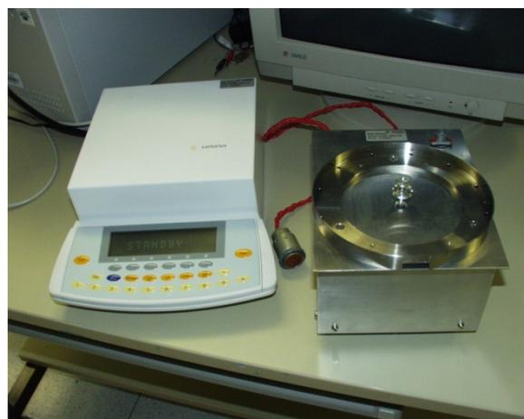
Abbildung 3.10: Präzisionswaage: Bedieneinheit (links) und Wägezelle (rechts)
