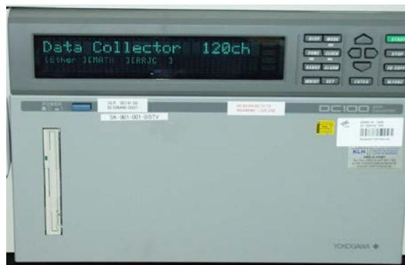
**Abbildung 6:** Messwerverfassung Yokogawa DC100 mit Anzeigedisplay
