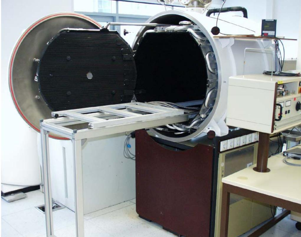
**Abbildung 5:** Sonnensimulationsanlage SSA
