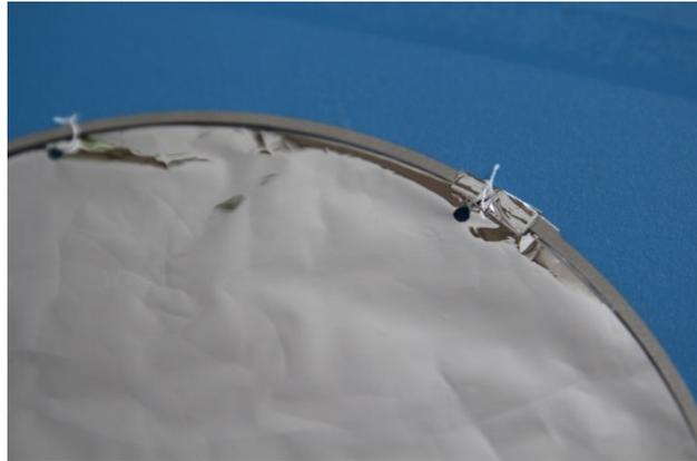
Abbildung 3.3: Elektrische Kontaktierung der Segelfolienprobe
