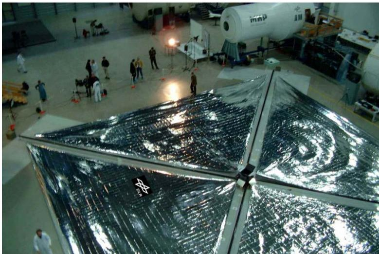
Abbildung 1.5: komplett entfaltetes 20x20 m<sup>2</sup> Sonnensegel beim DLR Köln [6]
