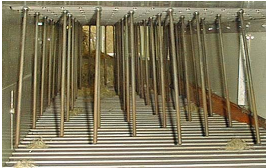
Abb. 5.18: Kammschüttel mit Winkelrost und zylindrischen Stahlzinken
