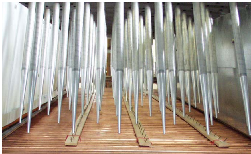
Abb. 5.19: Kammschüttel mit Kupfer-Stabrost und mit Spitzen versehenen Konstruktalzinken
