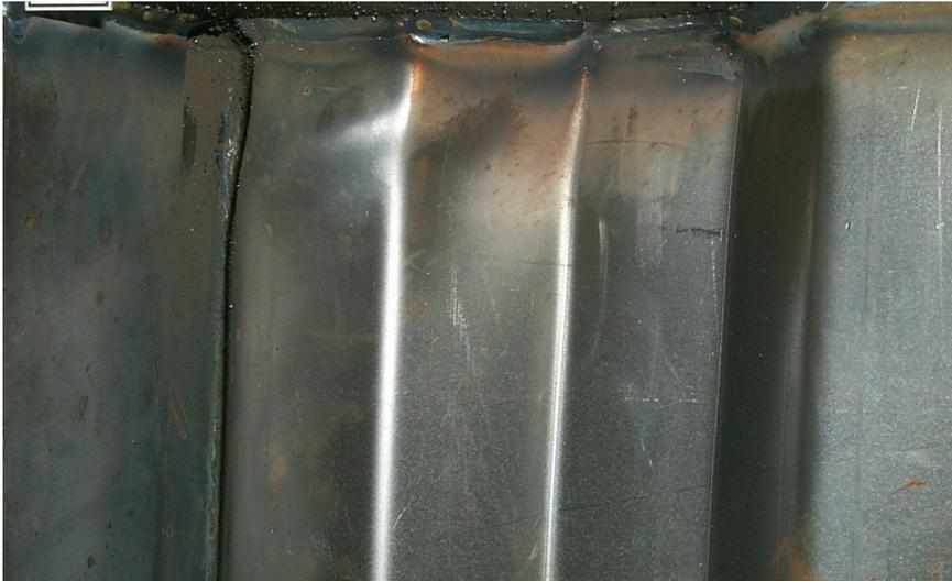
*Bild 4.4: Beulen im Lasteinleitungsbereich des plastizierten Steges Reihe V1 (Phase 1)*
