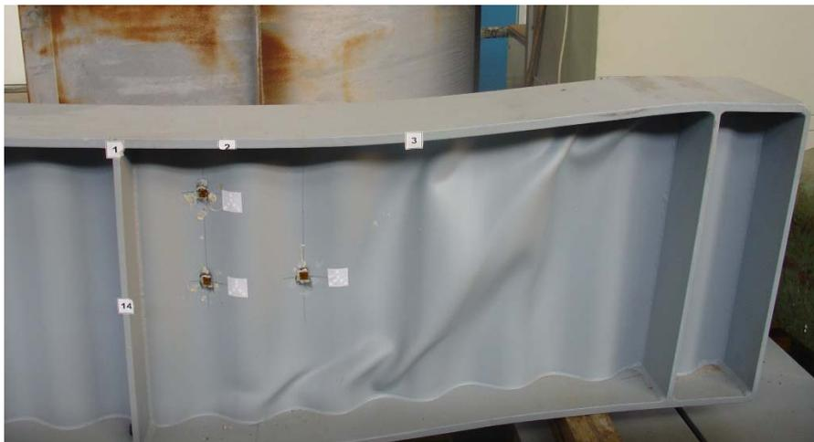
Bild 4.20: Versuchsträger V2\_01 Nachbeulbereich
