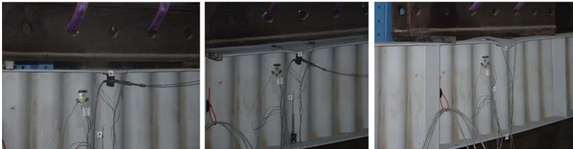
Bild 5.3: Gurtbeule bei Traglast und weiterer Laststeigerung
