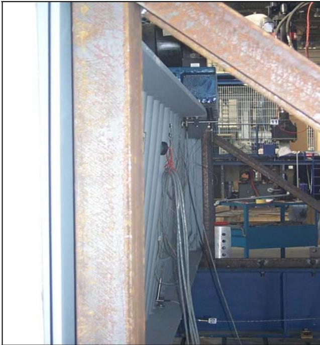
Bild 6.4: Biegedrillknicken des Trägers V6c
