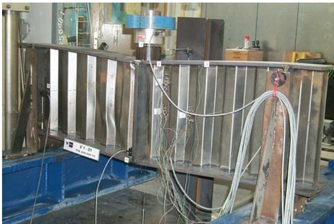
Bild 4.1: Versuchsaufbau und Messtechnik der Versuchsträger
