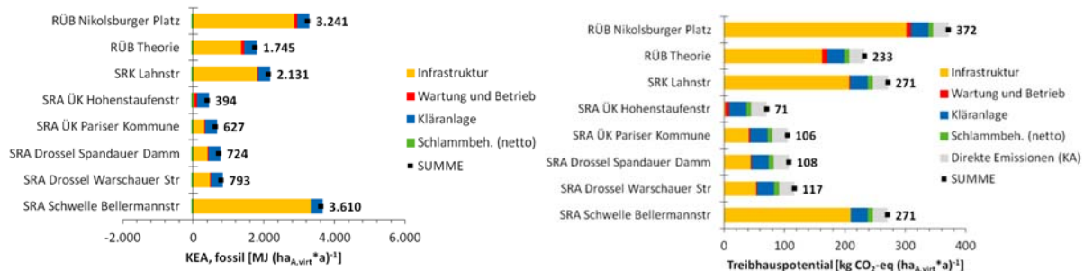
Abbildung 3.25. Kumulierter Energieaufwand (links) und Treibhauspotenzial (rechts) für Maßnahmen im Mischsystem
