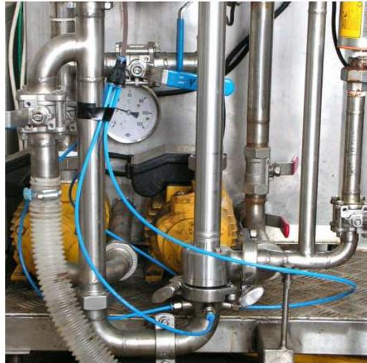
Abb. 43: Zufuhr von Gas im UF-Bodenstück, eigene Darstellung
