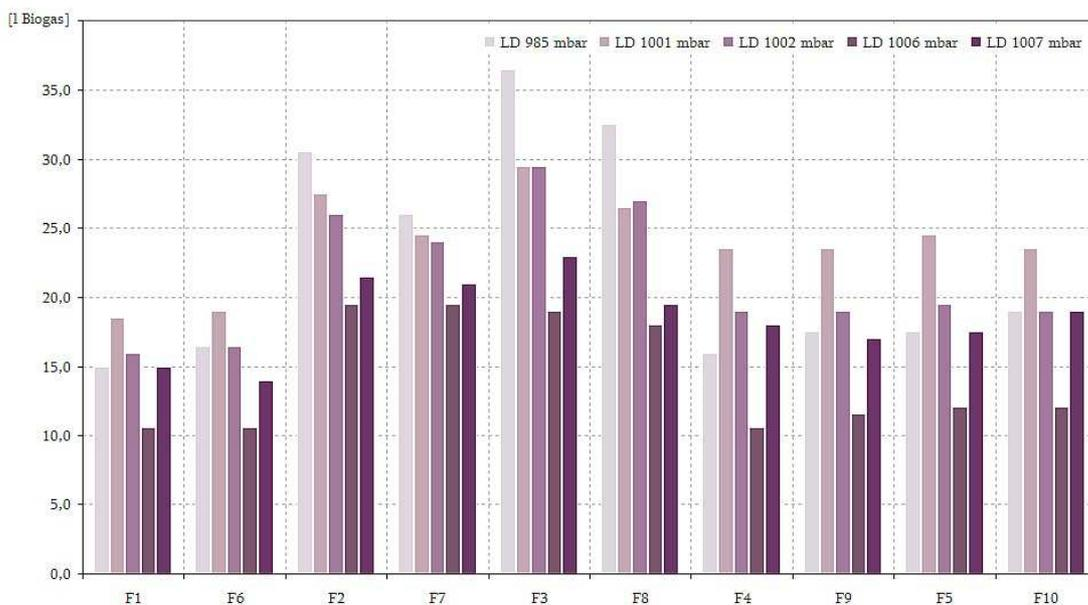
Abb. 84: Biogasertrag der einzelnen Substrat-Varianten, nach Laborprotokollen, Biogaslabor, FH Bingen (2012)
