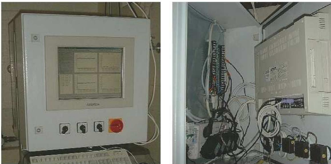
Abb. 53: Meßwerterfassung mit Panel-PC, eigene Darstellung
