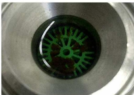
Abb. 61: Aufschwimmender Membranbelag nach chem. Reinigung, eigene Darstellung
