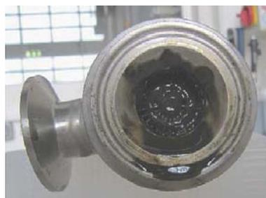
Abb. 77: Verblockung der 300 kDa UF-Membran, eigene Darstellung
