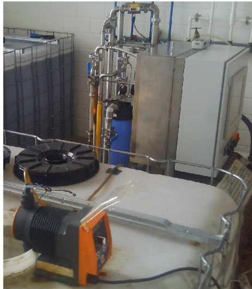
Abb. 45: Dosierpumpe auf Dünngületank vor Pilotanlage, eigene Darstellung
