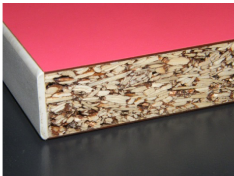
Abb. 3.7: Hanfschäbenplatte mit einem komplett substituierten Holzanteil
