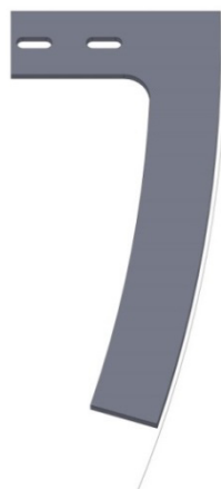
Abb. 5.28: Optimiertes Paddel mit angepasster Außenkante an die Siebflächengeometrie für einen Steigungswinkel \alpha = 25^\circ
