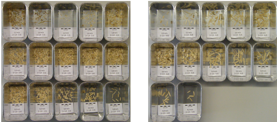
Abb. 5.38: ausgetragene Schäben zweier Siebfraktionen nach einem Versuchsdurchlauf (links: >1,0 - 2,5 mm, rechts: >2,0 - 4,0 mm)
