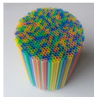
Abb. 5.34: engmaschige Siebflache als Aufgabeflache (links) und darunter sitzender Gleichrichter aus Strohhalmen (rechts)
