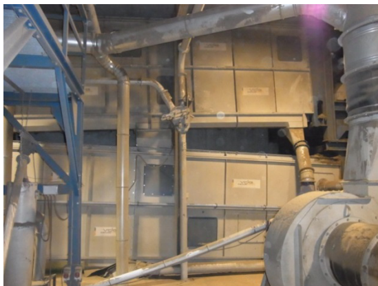
Abb. 4.18: Siebtrommelturm nach dem Prinzip von Dun Agro, gebaut durch die Firma Van Dommele (3D Schema rechts: [Dun et al., 2009])
