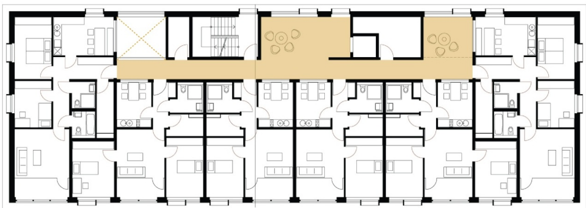
Abb. 4.4.4-7 Der geschlossene Laubengang stellt nicht nur einen gemäß DIN 18040 stufenfreien Zugang zu den Wohnungen her, sondern bildet zudem über Nischen und Lufträume den täglichen Kommunikationsraum für die Bewohner.
