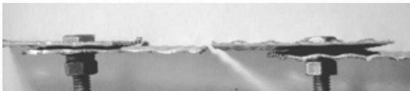
**Abbildung 149:** sich aufbiegende Blechränder bei  $M_{An}=10\text{ Nm}$ , links- stabile Lage, rechts- labile Lage
