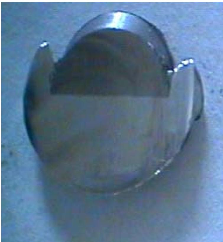
Abbildung 70: Videoaufnahme eines metallographischen 45°-Schliffs in der Fügeebene - Ansicht der Schweißtulpe bei einer Reibschweißverbindung
