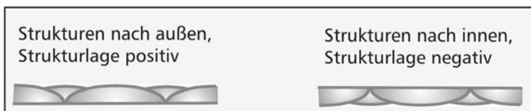
Abbildung 96: „Struktur Lage positiv“ und „Struktur Lage negativ“ für kugel- und beulstrukturierte Feibleche
