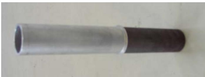
Abbildung 13: Durch Reibschweißen hergestelltes Verbundrohr aus Stahl und Aluminium
