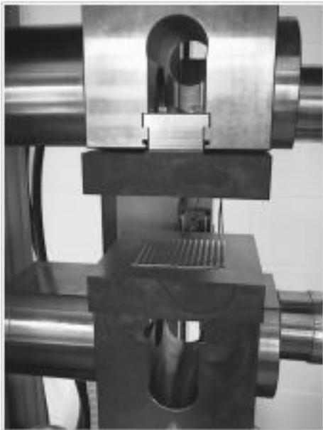
**Abbildung 100: Einebnungsversuch auf der Prüfmaschine**
