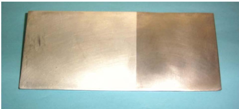
Abbildung 88: Durch Walzen hergestelltes Aluminium-Stahl-Tailored-Blank [146]
