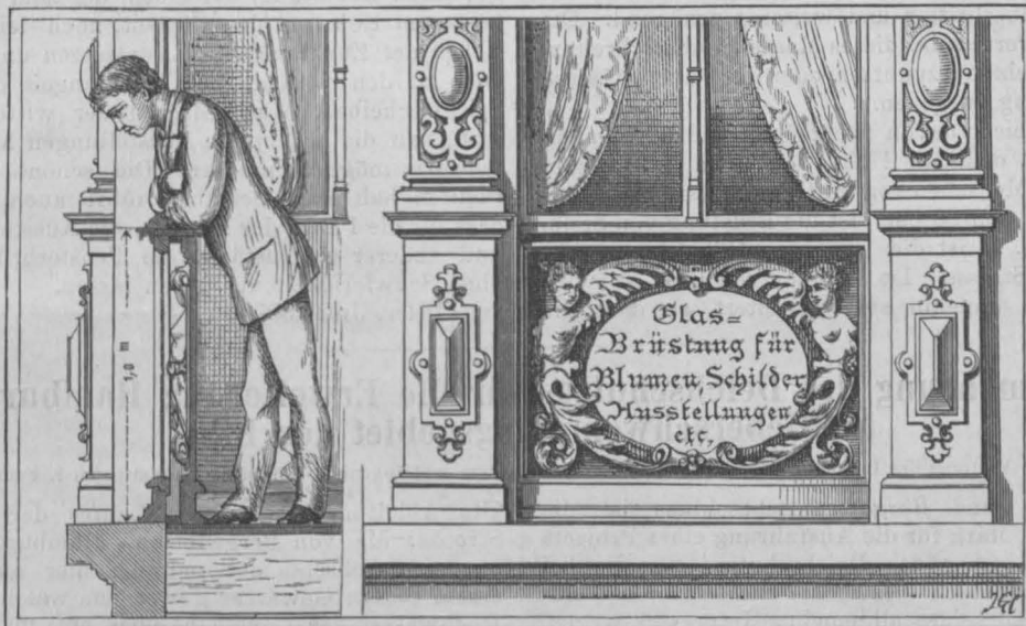
Fenster mit Glasbrüstung.
