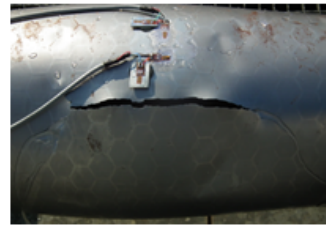
Abbildung 9: Versuchsbehälter aus strukturiertem Blech vor und nach einem Druckversuch.[4]
