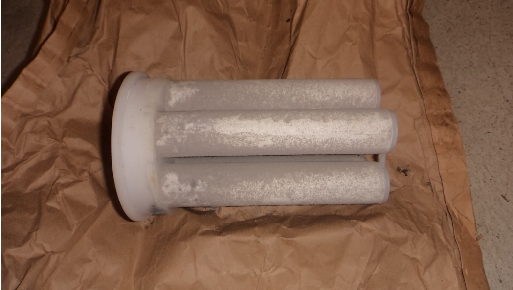
Abbildung 49: verschmutzter Anlagenfilter der Versuchsanlage (Nettomaterialkosten ca. 300 Euro)
