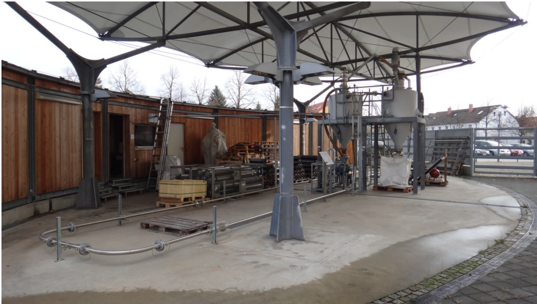
Abbildung 18: Versuchsanlage für Pneumatische Förderung am Institut für Maschinenbau und Management
