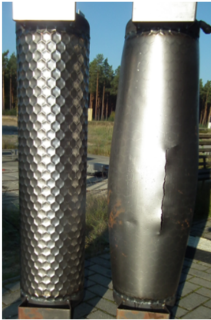
Abbildung 9: Versuchsbehälter aus strukturiertem Blech vor und nach einem Druckversuch.[4]
