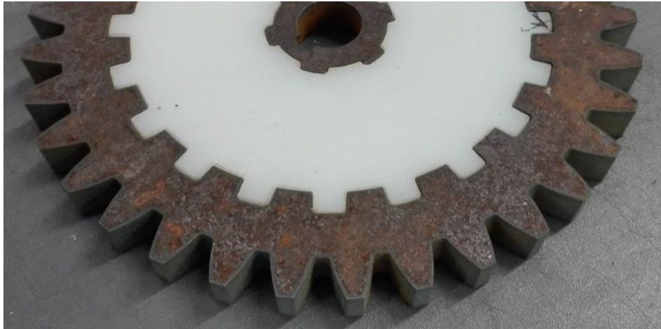
Abbildung1: Wasserstrahlgeschnittenes Metall – Kunststoff – Verbundzahnrad (BTU)
