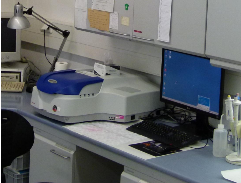
Abb. 22: Verwendetes Photometer, Specord 200 Plus von Analytik Jena, zur Gesamtphosphoranalyse.
