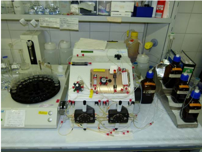
Abb. 24: Verwendete FIA compact von MLE GmbH Dresden zur Gesamtstickstoffanalyse.
