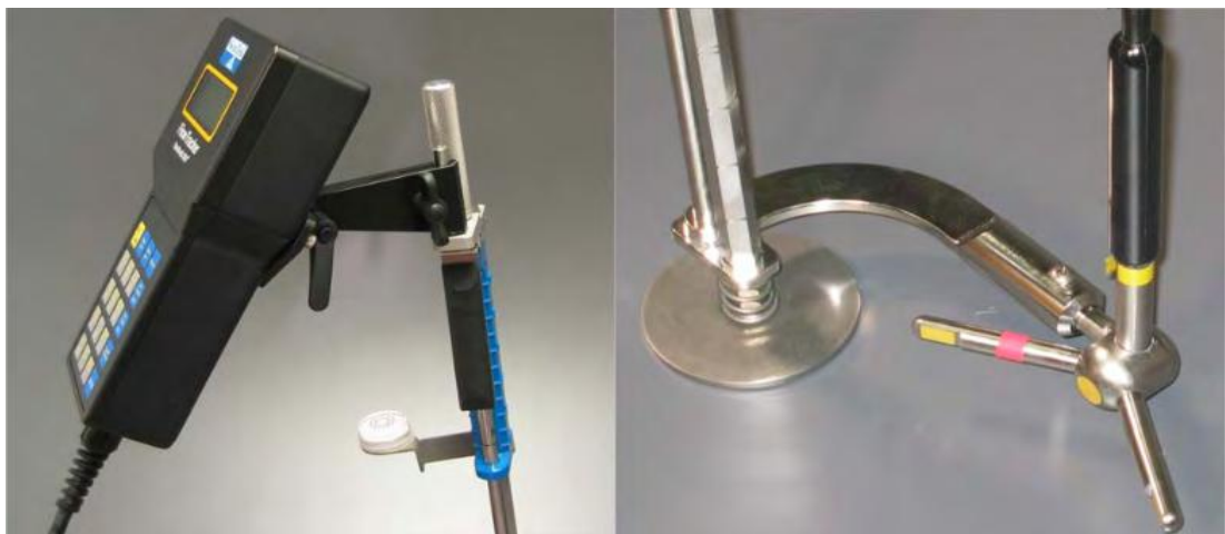
Abb. 14: FlowTracker, links: Bediengerät; rechts: Messsonde.
