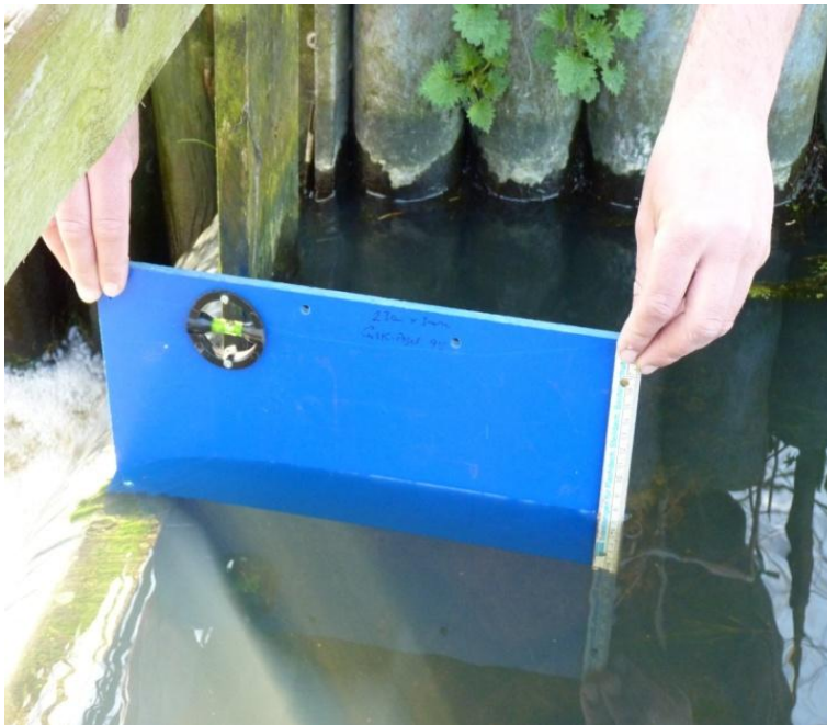
Abb. 17: Überfallmessscheibe zur Berechnung des Durchflusses mit der Berechnungsformel nach Poleni (Bollrich, 2000).
