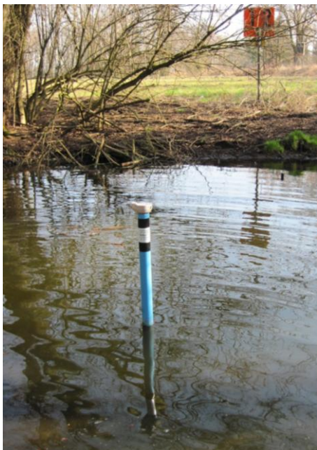
Abb. 19 und 20: links: Pegellogger MDS3A-Insider von Seba Hydrometrie GmbH im Stahnsdorfer Fließ (STAEI); rechts: Pegellogger CTD-Diver von Schlumpberger Water Services vor dem Einsetzen in das Stahnsdorfer Fließ.
