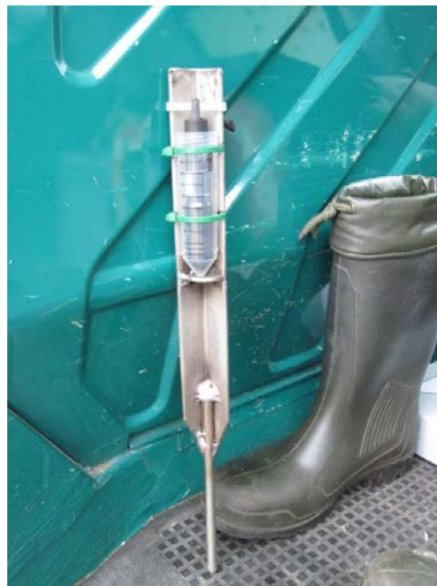
Abb. 19 und 20: links: Pegellogger MDS3A-Insider von Seba Hydrometrie GmbH im Stahnsdorfer Fließ (STAEI); rechts: Pegellogger CTD-Diver von Schlumpberger Water Services vor dem Einsetzen in das Stahnsdorfer Fließ.
