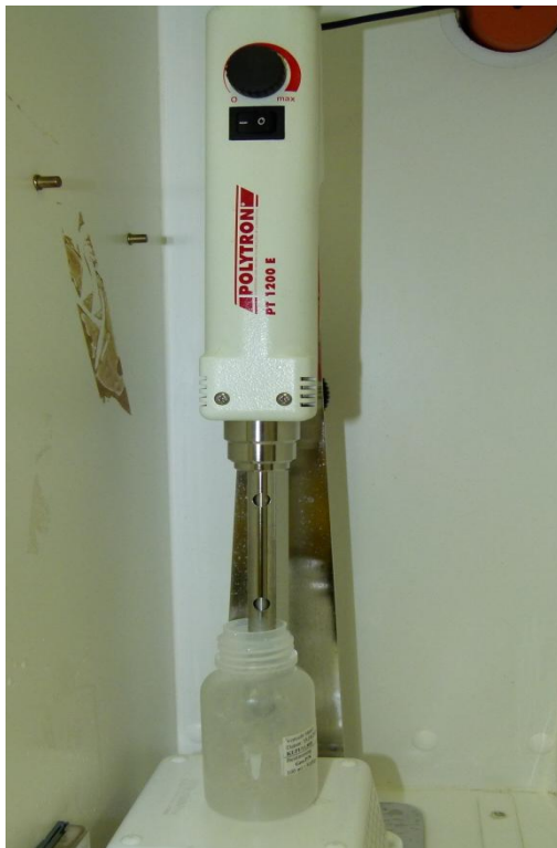
Abb. 21: Verwendetes Gerät zum Homogenisieren der Proben (PT 1200 E von Polytron).
