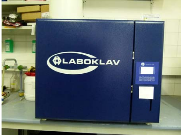
Abb. 23: Für TP-Aufschluss verwendeter Autoklav LABOKLAV 55-M der Firma Steriltechnik AG.
