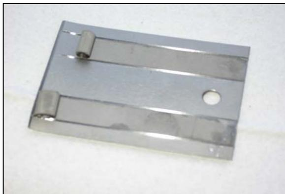
Abb. 4.2 Blechprobe mit zwei gefrästen Streifen nach dem Abziehtest.
