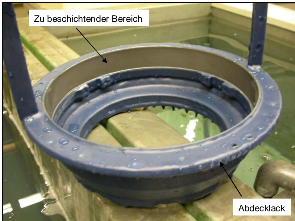
Abb. A60 Aktivgebeiztes Triebwerksausschussbauteil (Lagerring vom Hochdruckverdichter, Stufe 3) bei der Erprobung in der Fertigung.
