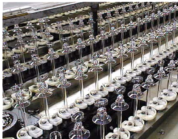
Abbildung 8-1: Gestelle auf dem Produktionsband (Quelle: OSRAM GmbH)
