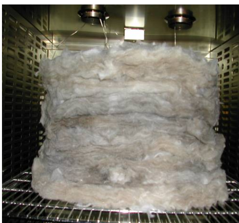
Abbildung 4.2.3.1.1-1: Versuch mit erhöhtem Wärmestau, LEX-Packung in Glaswolle
