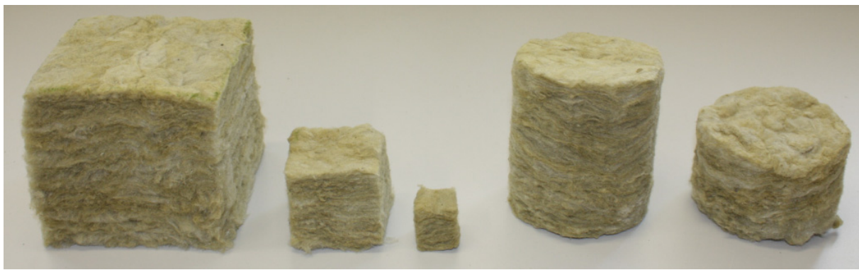
Abbildung 4.2.1-1: Verschiedene unbenetzte Proben Steinwolle 1.000\text{ cm}^3 , 125\text{ cm}^3 , 8\text{ cm}^3 , 400\text{ cm}^3 , 240\text{ cm}^3
