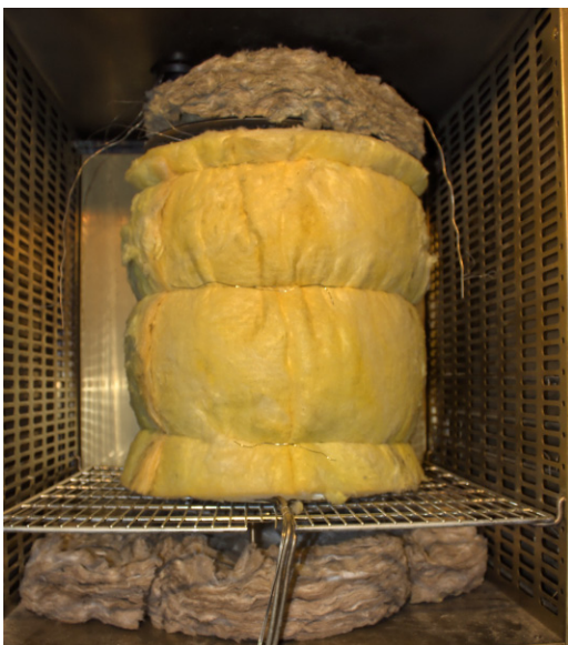
Abbildung 4.2.3.1.2-1: Versuchsaufbau für (über)adiabaten Versuch, links: gedämmte Ringheizung; rechts: benetzte LDX-Packung in Ringheizung
