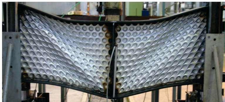
Abbildung 3-31: Träger V08.1 am Ende des Versuchs
