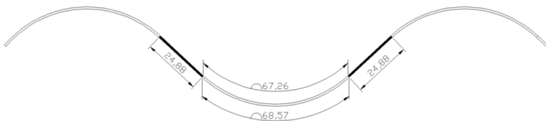
Abbildung B-2: Zugprobenentnahme aus dem Wellblech
