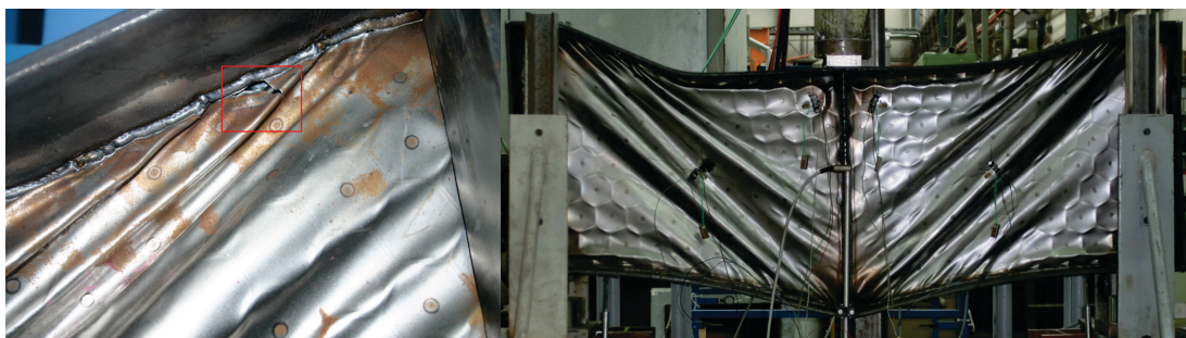
Abbildung 3-34: Riss des Stegbleches von V04.1 (li.) und Träger V13.1 während des Versuchs (re.)
