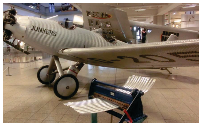
Abbildung 1-1: Maschine zur Wellblechherstellung und verbaut als Flugzeugbeplankung
