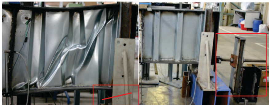
Abbildung 3-13: Schiefstellung Rolllager (li.), verändertes horizontales Auflager (re.)
