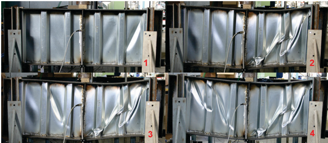
Abbildung 3-14: Verlauf des Beulens des Trägers V02.2
