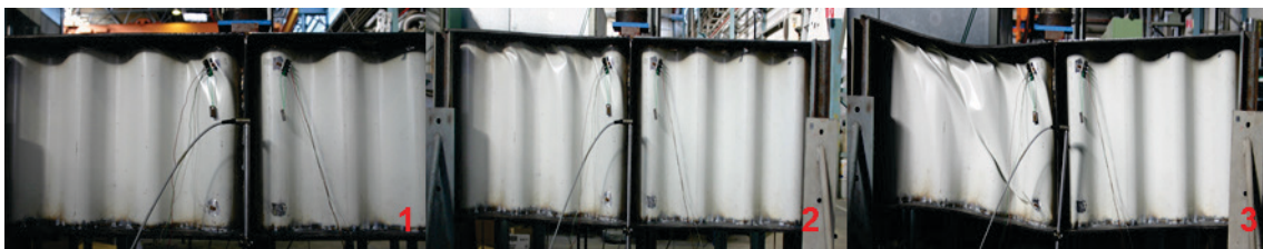
Abbildung 3-22: Verlauf des Beulens des Trägers V003.1
