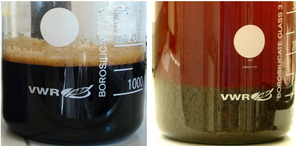
Abbildung C.4: Schwarzlauge mit etwa 44 Vol% Glycerin vor (links) und nach (rechts) weiterer Verdünnung und Ligninfällung.
