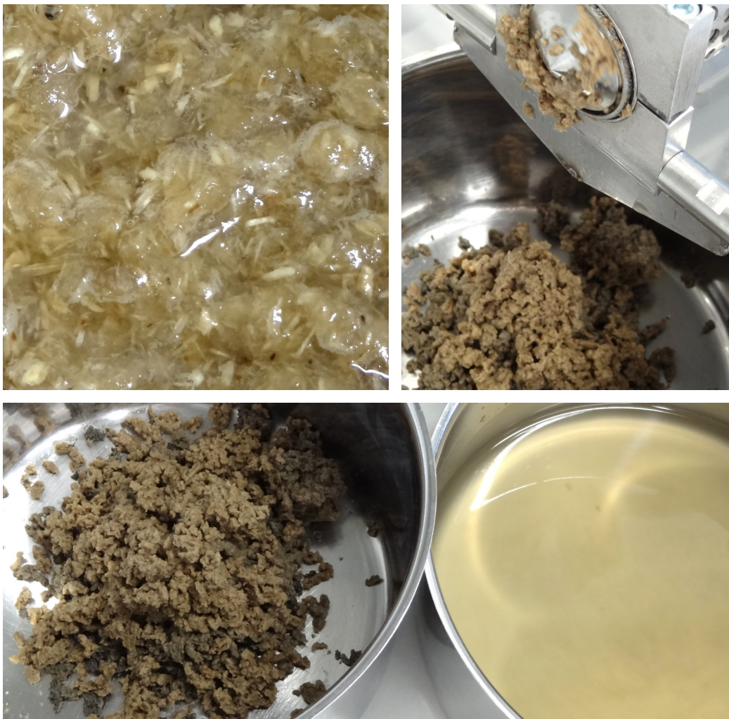
Abbildung D.11: Wässrige Zellstoffsuspension vor (oben links), während (rechts oben) und nach (unten) der Fest-Flüssig-Trennung in der Schneckenpresse.
