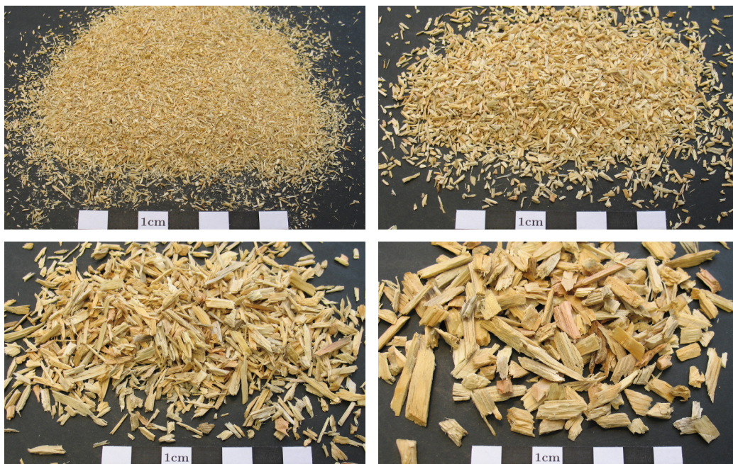
Abbildung C.1: Kiefern schnitzel der Fraktionen 0,1–1 mm (oben links), 1–2 mm (oben rechts), 2–4 mm (unten links) und 4–6,3 mm (unten rechts).
