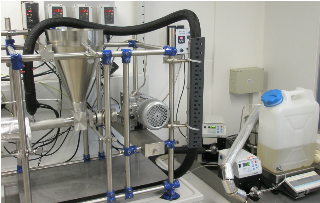
Abbildung D.6: Gesamtansicht der Bereitstellung der Aufschlusslösung sowie der Antriebseinheit und Einzugszone des Extruders.
