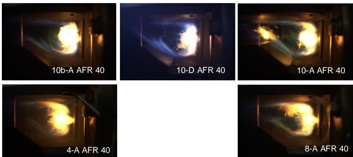
Bild 7.6: „Wide Cone“ Flammen (in jedem Bild unten sind die Swirlparameter)
