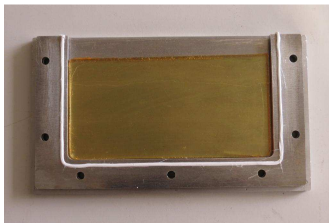
Abbildung 6-2: Stehendes Werkzeug zur Herstellung von Reinharzprobekörpern
