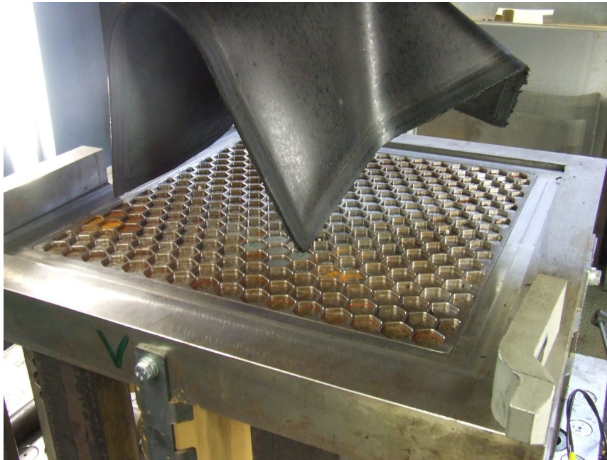
Abbildung 3.2: Blick auf einen Teil der Presse zur Fertigung strukturierter Bleche durch Hydroumformung, mit sichtbarer Matrize mit Wabenstruktur und gummierter, entleerter Membran
