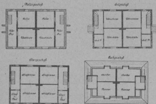
Abb. 1 und 2. Erster Entwurf eines Familienwohnhauses ohne — zweiter Entwurf mit wesentlicher Berücksichtigung wärmetechnischer Grundsätze.
