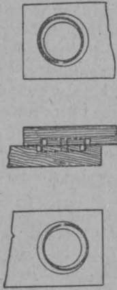
Abb. 2. Ringdübel in etwas zu großer Nut liegend.
