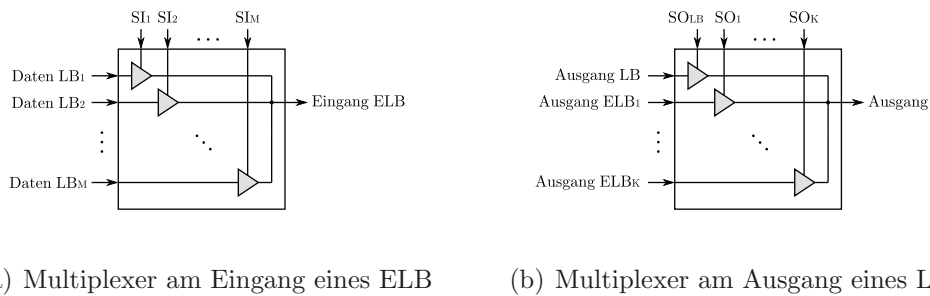
Abbildung 4.3: Implementierungen der Multiplexer des RLB aus Abbildung 4.1
