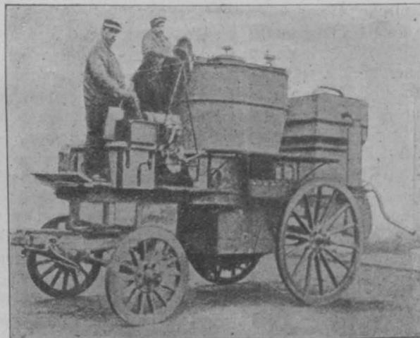
Abb. 8. Wasserstoffgenerator nach dem Kalziumhydridverfahren.
