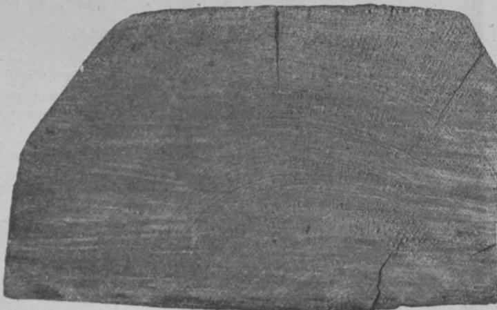
Abb. 32. Schnitt durch dieselbe Schwelle, zeigt die Merkmale der Überständigkeit.
