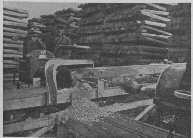
Abb. 34. Dübelung von Buchenschwellen nach System Mauthner. Rechts Bohrmotor nach vollzogener Bohrung, links Gewindschneider bei der Arbeit.
