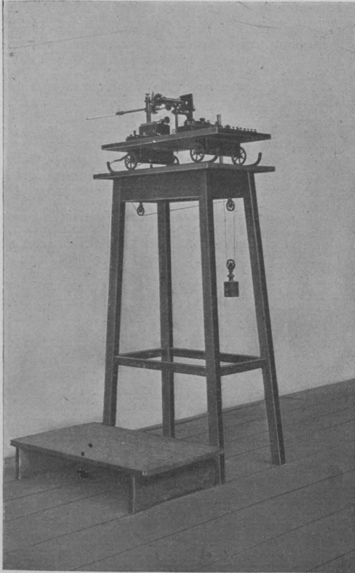
Abb. 4. Stimmgabel-Sonometer zur Messung von Wandamplituden.
