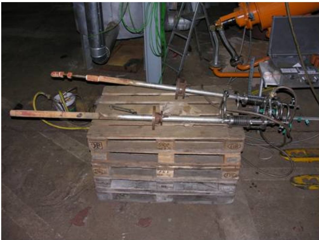
Abbildung 3.12: Eingesetzte wasser- und luftgekühlte Korrosionslanzen
