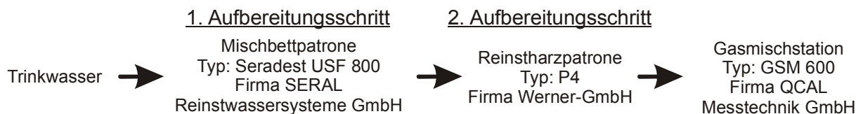
Abbildung 3.5: Aufbereitungsschritte des eingesetzten Wassers
