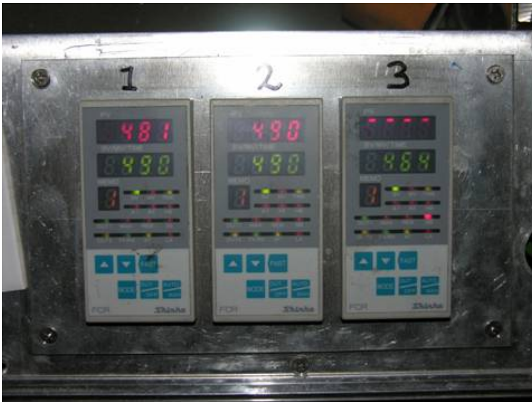
Abbildung 3.13: Steuereinheit zur Regelung der Materialoberflächentemperaturen
