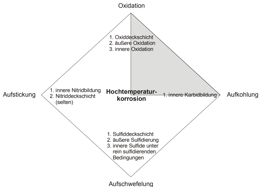
Abbildung 2.18: Einteilung der Hochtemperaturkorrosion in ihre Grundtypen
