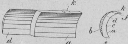
24.—23373 **Vergasungsbrenner fur flussige Brennstoffe.** Alex. Friedmann und Richard Knoller, Wien. An das Zuleitungsrohr des vergasteten Brennstoffes ist nach den Austrittsoffnungen eine Ableitung (*a*) oder ein Uberlaufraum fur den kondensierten Brennstoffdampf angeschaltet, um dessen Entweichen durch die Dampfaustrittsoffnung zu verhindern. Die Ableitung kann in den Verbrennungsraum ragen, um eine Nachverdampfung zu ermoglichen.
