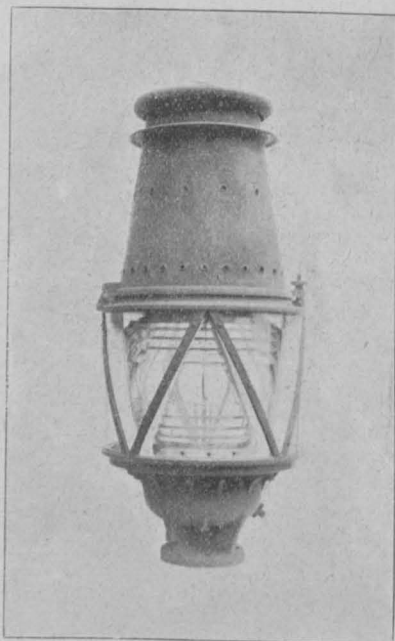
Fig. 17. Leuchtapparat mit Fresnel'scher Linse von 300 mm Durchmesser. (Gewicht ca. 125 kg.)
