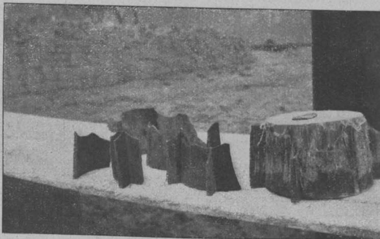
Abbildung 10. Aufgegrabener Pfahlkopf mit zerstörtem Gußeisenring. Holzpfähle mit Eisenbetonaufsatz System Heimbach.
